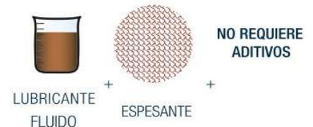
En las grasas de sulfonato de calcio, el espesante conforma una interface única de placas o escamas entre los cuerpos, que corresponden a la estructura del espesante, tal como lo muestra el gráfico.
